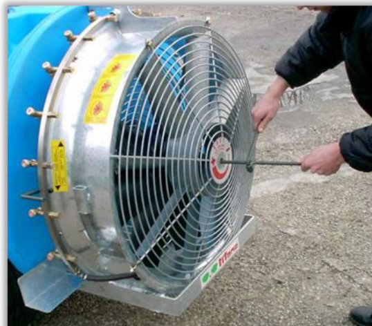
Regulacja wydajności wentylatora - kąt łopatek wirnika
