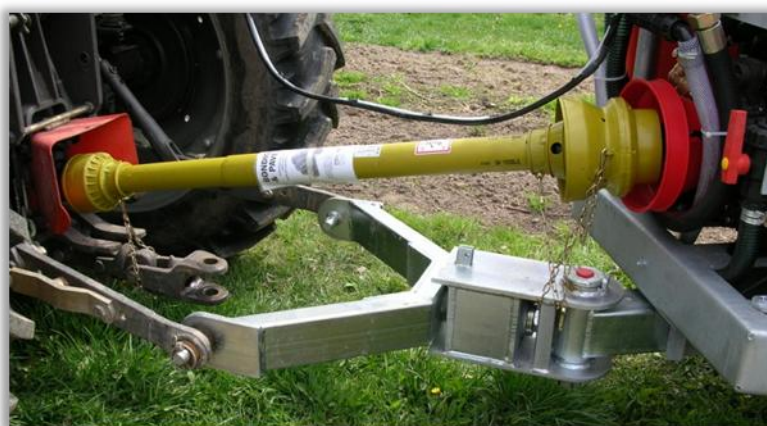
Zabezpieczenia zaczepu i wałka przegubowo-teleskopowego oryginalnymi sworzniami i zawleczkami
