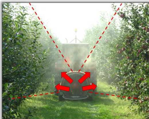
Strumień powietrza powinien być dostosowany do korony drzewa
