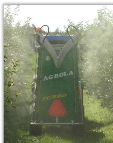
Wentylator osiowy z deflektorem - z odwróconym ciągiem
