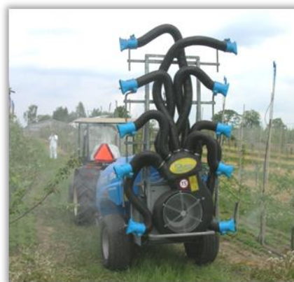
Opryskiwacz z wentylatorem promieniowym - kierowany strumień powietrza
