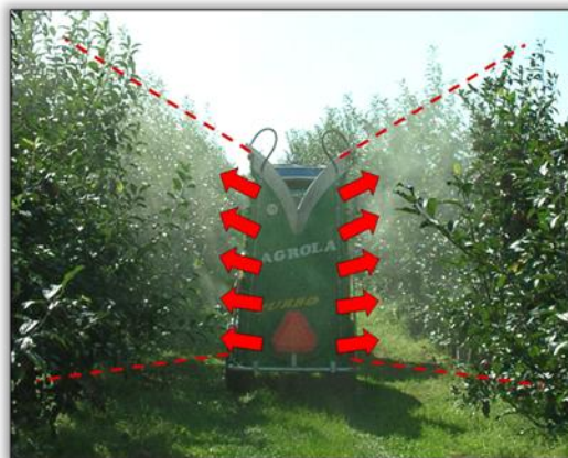
Strumień powietrza powinien być dostosowany do korony drzewa
