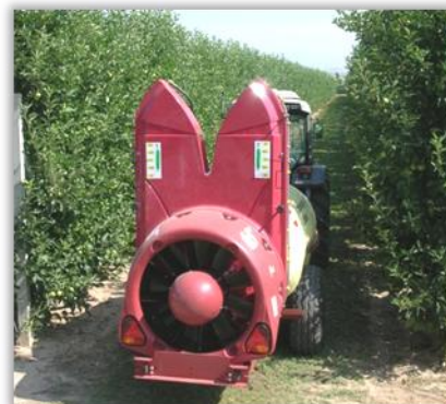
Opryskiwacz z wentylatorem osiowym z deflektorem
