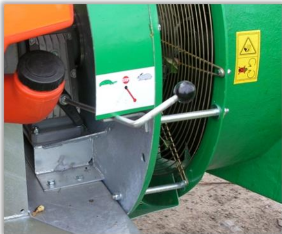
Zmiana wydajności wentylatora - przełożenie przekładni wentylatora
