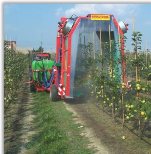
Opryskiwacz tunelowy z odzyskiwaniem cieczy użytkowej
